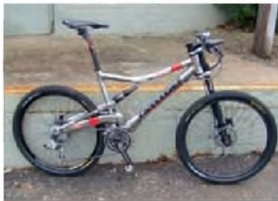
▲ Figura 22.40 Materiales compuestos (“composites”) de carbono. Estos materiales tienen un gran uso en aplicaciones aeroespaciales y automotrices, y en artículos deportivo. Estas llantas de bicicletas de alto rendimiento (y de alto costo!) tienen un armazón de material compuesto de fibras de carbono, lo que las hace muy ligeras y las ayuda a absorber golpes en el camino.
